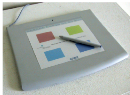
Abb. 26: Einfache Anordnung zur Demonstration der verschiedenen Kategorien von Oberflächentexturen. Bei der Interaktion mit dem Stift auf den verschiedenfarbigen Flächen werden unterschiedliche Textur-Kombinationen hörbar.
